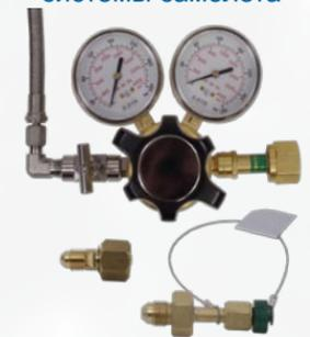
Регуляторы и переходники для заправки систем самолета азотом
