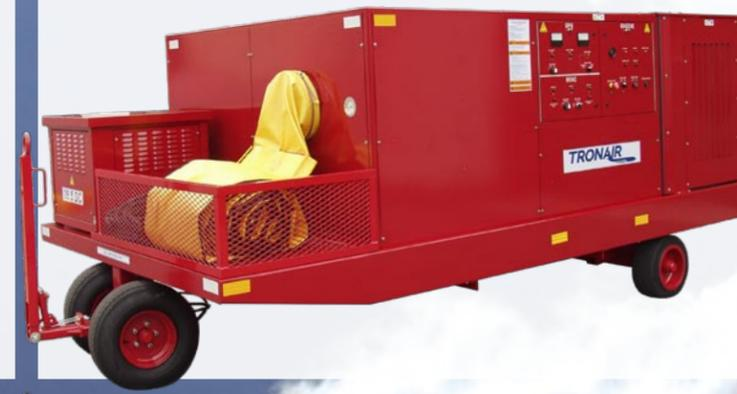
Устройства для проверки и заправки гидравлической жидкости и масла двигателя
